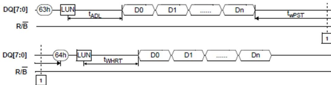
Figure 128 Write DQ Training (Tx side)
